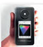
Spectromètres portables et autonomes
